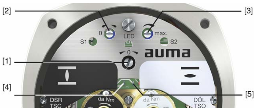
рис. 33: Вид на блок выключателей с открытой крышкой отсека
